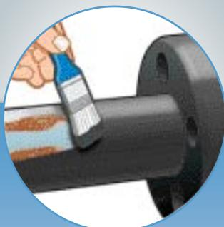
Traitement de surface et protection anti-corrosion
