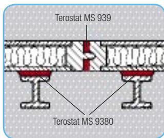
Collage/étanchéité des panneaux latéraux sur des structures porteuses
