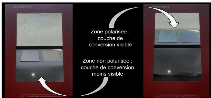
Figure 3 - Bonderite Viewer sur alliage 2024 T3 et 7075 T6. Source : Henkel
